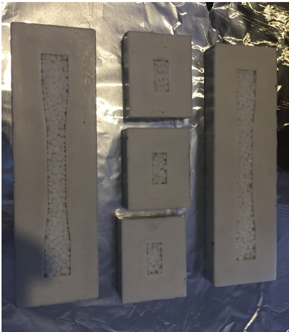
Ilustración 35.- Vaciado de PPc dentro de los moldes
