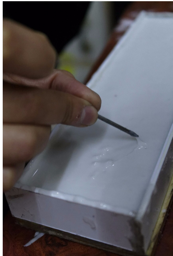
Ilustración 33.- Vaciado de caucho de silicón P-48
