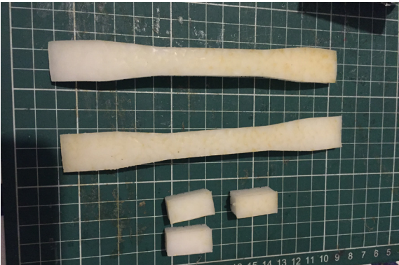
Ilustración 38.- Desmoldado de las probetas y perfilación
