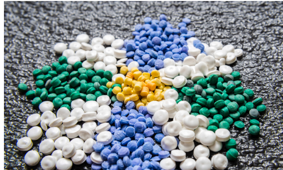
Ilustración 7.- Pellet de PVC virgen para su procesamiento en diversas fabricaciones. Teknor Apex.
