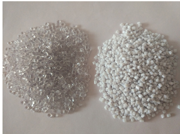
Ilustración 8.- Pellet de PET tras un proceso de secado precristalino por maquinaria STPLAS.
