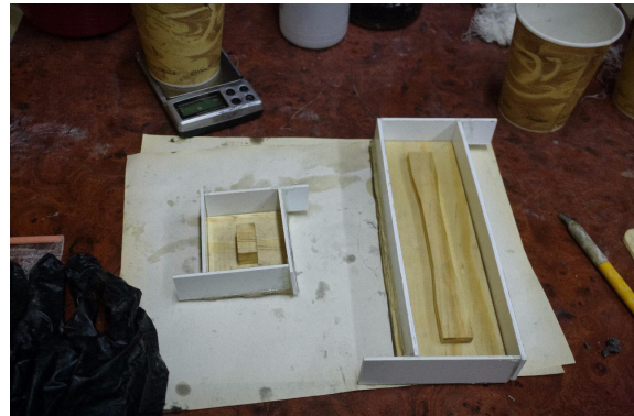
Ilustración 32.- Encofrado de positivos con poliestireno
