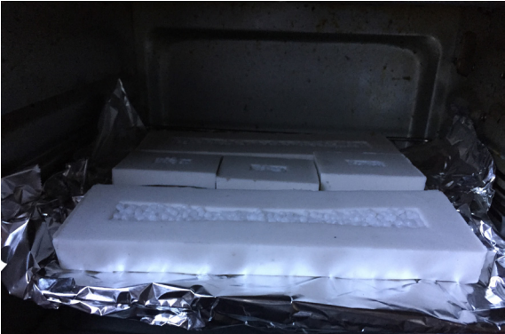
Ilustración 36.- Aplicación de calor uniforme en los moldeas a 450°F
