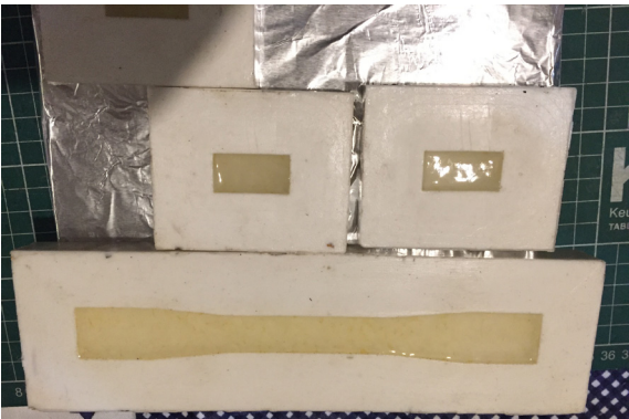
Ilustración 37.- Recuperación de los moldes tras 30min de aplicación de calor y proceso de enfriamiento a temperatura ambiente de 14°C
