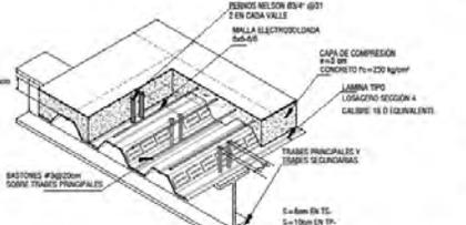
**SISTEMA DE PISO COLOCACIÓN DE LOSACERO EN TRABES (TP-Y-TS)**
