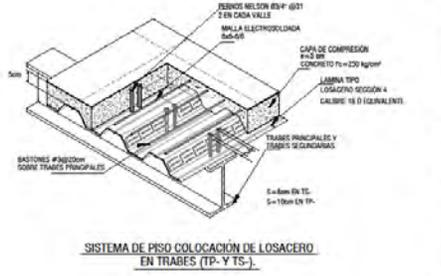
SISTEMA DE PISO COLOCACIÓN DE LOSACERO EN TRABES (TP - Y TS -).
