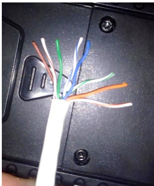
Figura 53 Orden de Hilos bajo la norma T-568B
