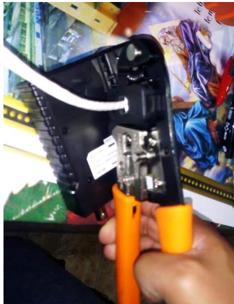
Figura 57 Ponchado de cable utilizando pinzas de crimpado.
