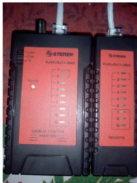
Figura 58 Prueba de cables mediante un tester.
