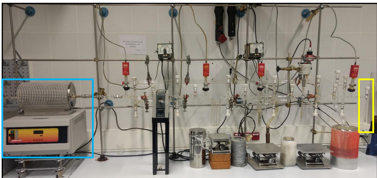
Figura 4.4. Línea de azufre, el proceso inicia a la izquierda en el horno (recuadro azul) y finaliza a la derecha en el coldfinger (recuadro amarillo) del Laboratorio de isótopos estables de la Universidad de Salamanca.
