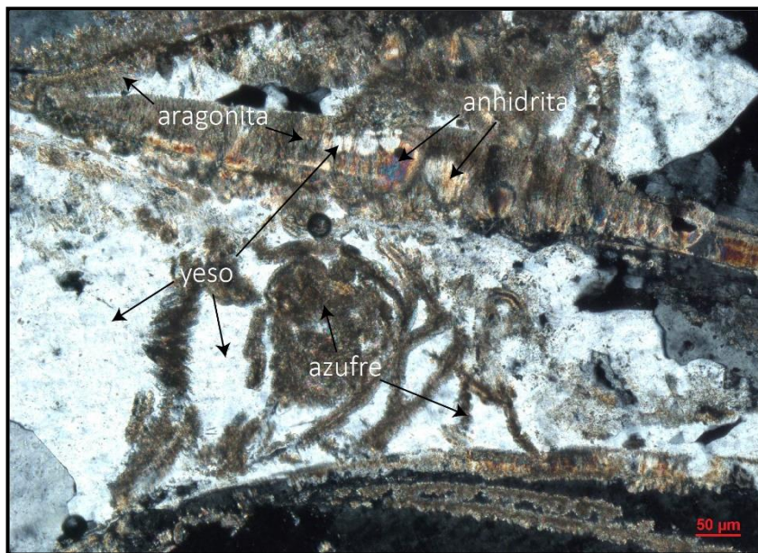
Figura 5.6. Lámina 1.1 a 10x donde se identifica aragonita, yeso, anhidrita y azufre.
