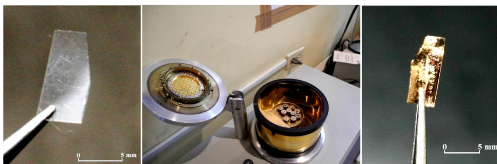
Imagen 78: Fragmento de polímero que se reblandece con una gota capilar de acetona y queda impreso el negativo de la superficie de los objetos (a); sputtering que recubre con iones de oro los polímeros previamente montados en pequeñas bases (b) y polímeros recubierto con iones de oro (Monterrosa, 2018: 154).
