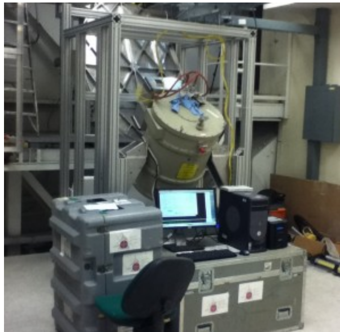
Figura 3.2.2: Cámara de continuo a 1.1 m, AzTEC, instalada en el cuarto de instrumentos científicos del GTM. Tomada de http://lmtgtm.org/telescope/instrumentation/instruments/aztec/?lang=es .
