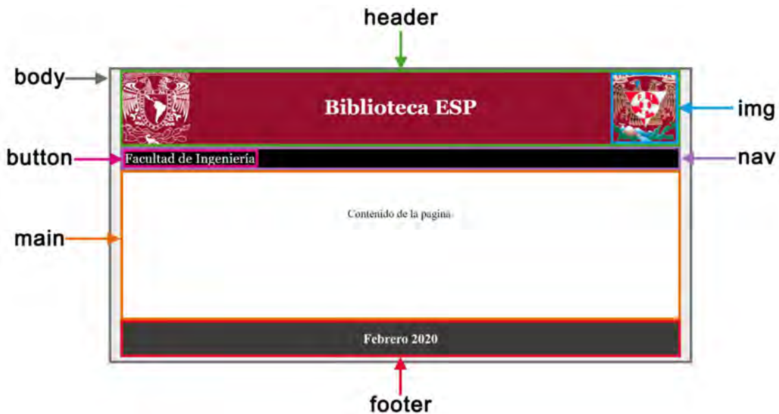
Figura P18-A.5 Composición de la página que se envía en la práctica 18-A
