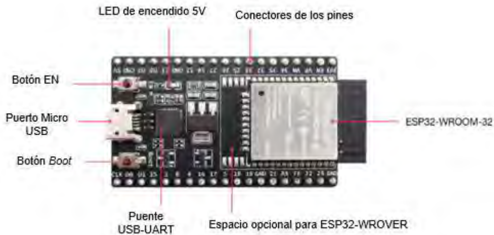
Figura 4.3 ESP32_DevKitC V4. Modificado de [57].
