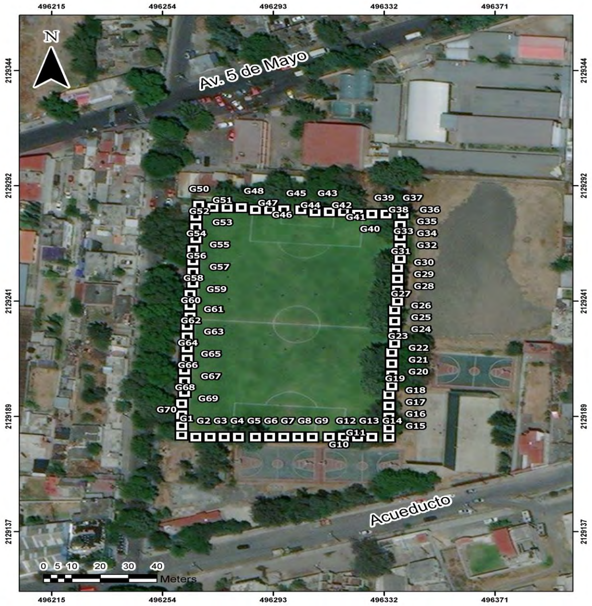
Figura 4. Geometría del arreglo de TIRSA. Los cuadros blancos indican la posición de los geófonos y la forma en que fueron numerados.
