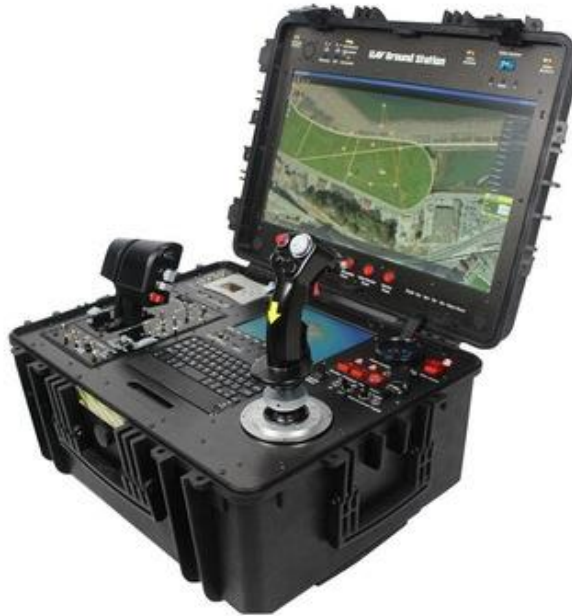
Imagen 3. Estación profesional terrestre para el pilotaje de una RPA.
