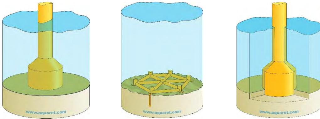
Figura 48. Sistema de anclaje con base fija por gravedad.
