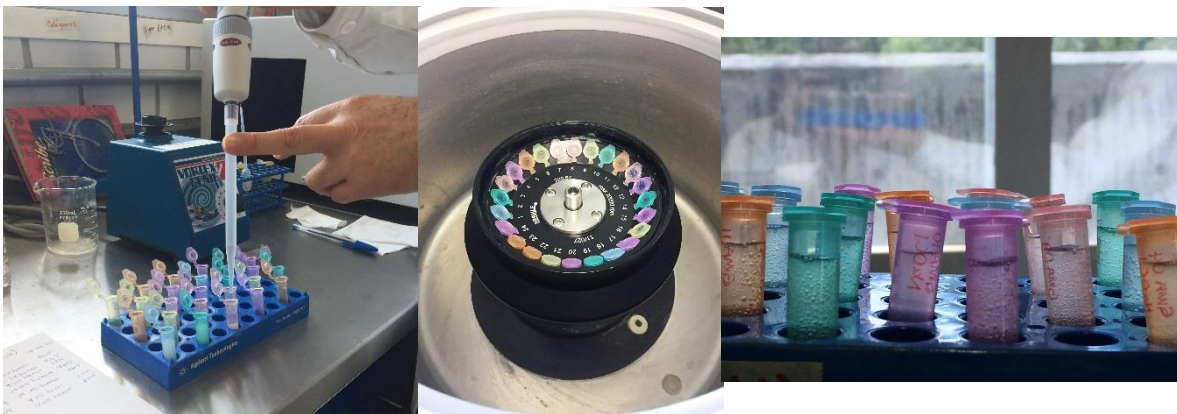
Figura 18 Limpieza química con NaOCl: adición de compuesto, centrifugado y adsorción de los carbonatos exógenos (evidente por la efervescencia). (GIMA, 2019)
