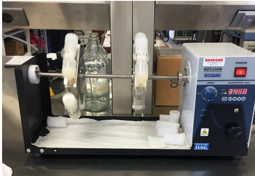
Figura 17 Agitación constante de las muestras en el proceso de limpieza con \text{H}_2\text{O}_2 . (GIMA, 2019)
