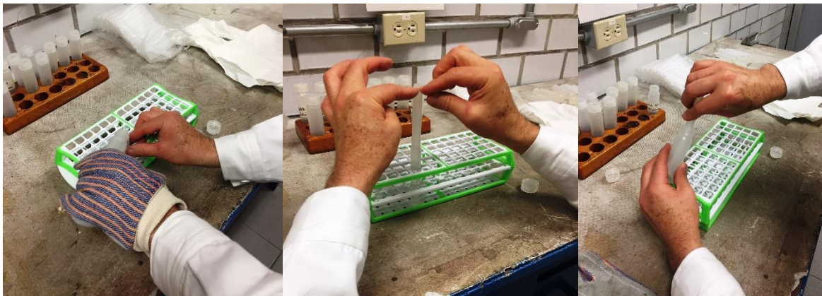
Figura 19 Filtración de la solución de colágeno en caliente. (GIMA, 2019)
