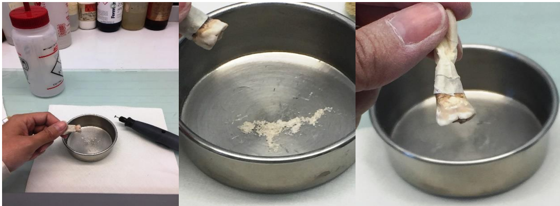
Figura 12 Separación mecánica del esmalte. (GIMA, 2019)
