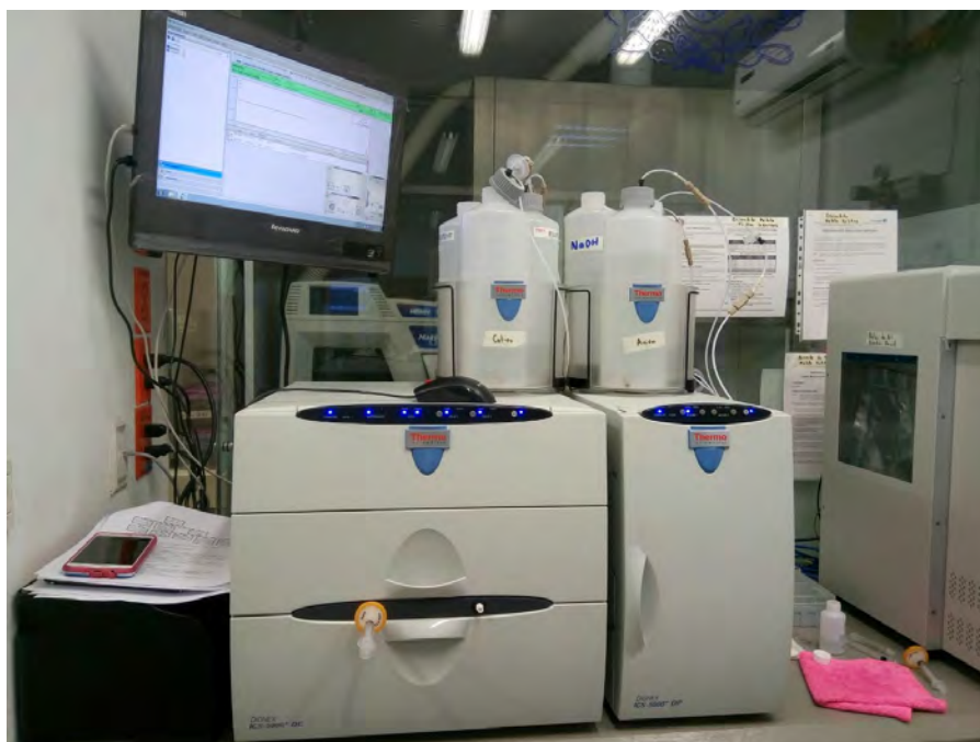
Figura 2.7: Cromatógrafo iónico de la UGFG. Equipo Dionex ICS-5000+DC Detector/Compartimiento de cromatografía.
