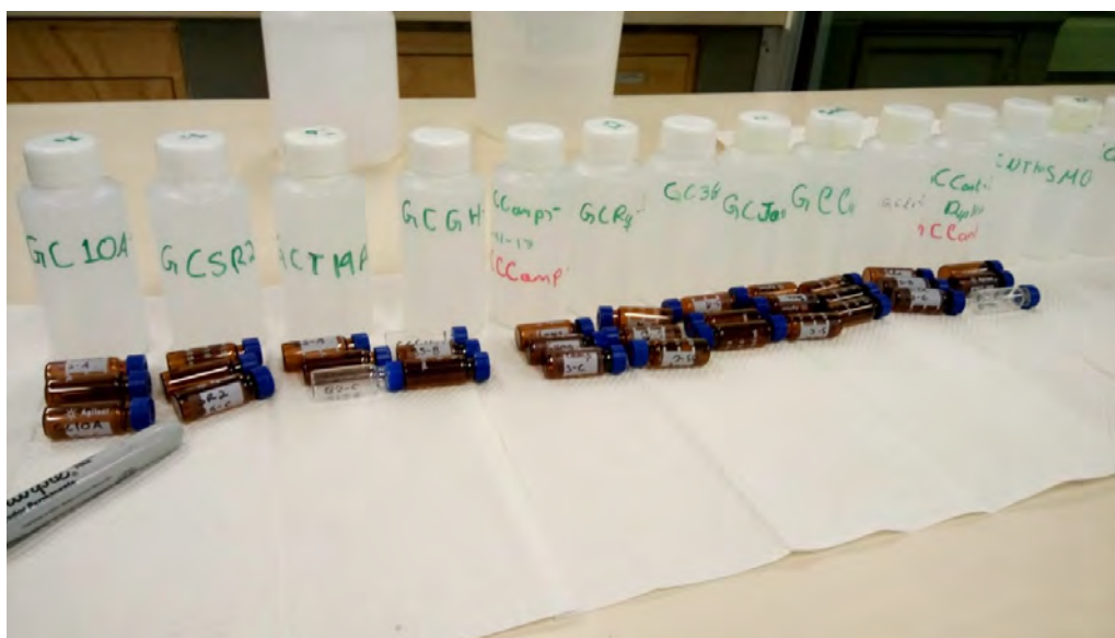
Figura 2.6: Viales de vidrio que se utilizaron para medir isótopos de \delta^2\text{H} y \delta^{18}\text{O}
