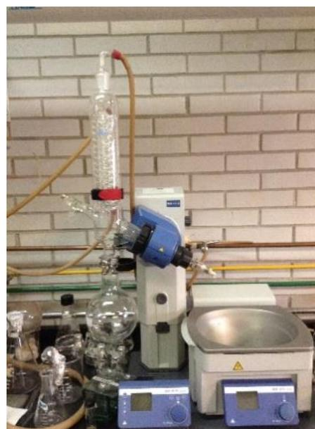
Figura 2. Destilación del extracto metanólico, en el rotavapor
