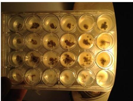
Figura 10. Inhibición del crecimiento radial de *Aspergillus niger*
