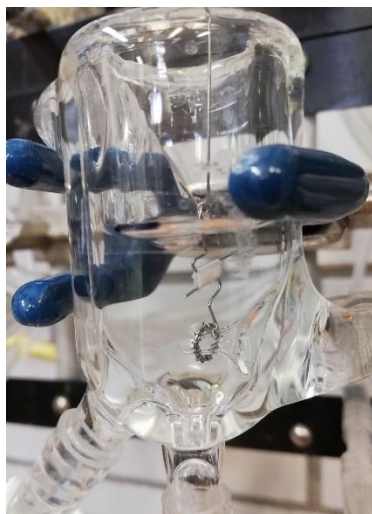
Figura 12. Aorta colocada entre dos ganchos de acero en una cámara del equipo de órgano aislado
