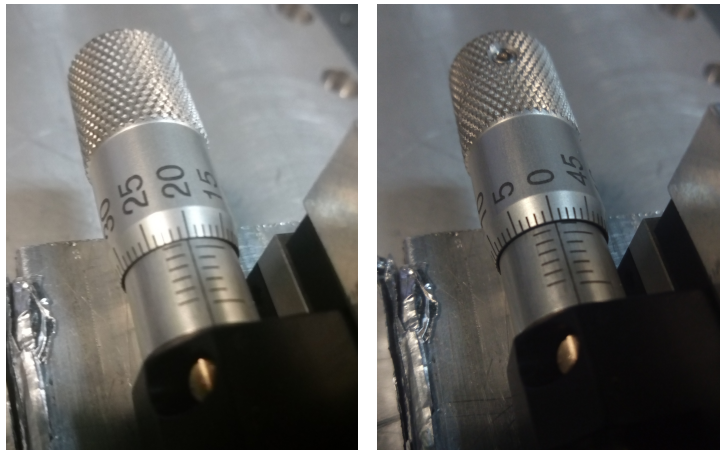
(a) Tornillo micrométrico con una ligera separación del tambor fijo con la escala graduada. (b) Tornillo micrométrico con una mayor separación del tambor fijo con la escala graduada.
