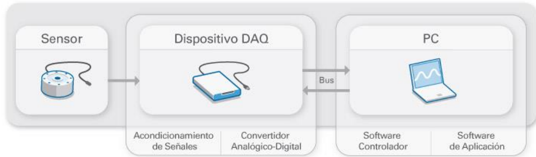
Figura 3. Partes de un Sistema DAQ. Primeramente, el sensor que mide la señal, después el hardware o dispositivo DAQ para la traducción de señales y finalmente la PC para implementar control. Fuente: (National Instruments, s.f.)
