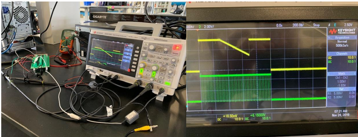
Figura 21. Utilización del osciloscopio adquirido durante las pruebas eléctricas para sincronizar las señales CTRL_SEL del LED blanco y la señal CTRL_PWM del LED naranja.
