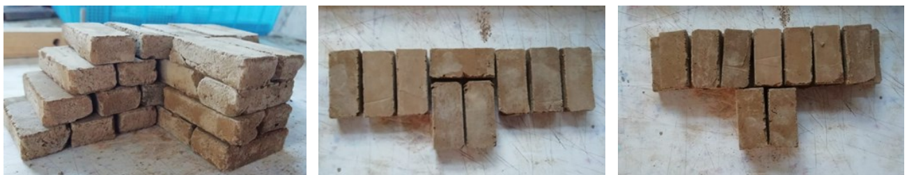
Img. 56–57–58 "LABPYSCT" (2019) 56. Refuerzos verticales 57. Aparejo A 58. Aparejo B [Fotografías del estudio] Equipo de seminario.
