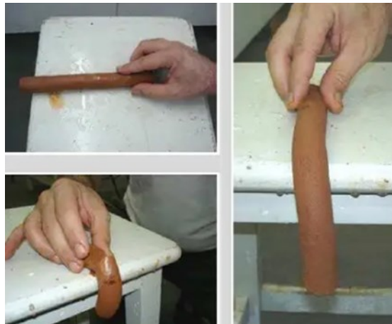
Img. 44 "PROTERRA" (2009) Prueba de la cinta. [Imagen ilustrativa] Carlos A. Mosquini
