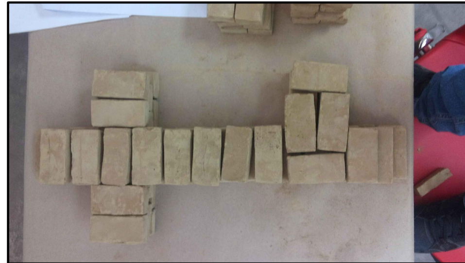
El modulo de adobe es de 10x20x40 centímetros, siendo este último el ancho de espesor de muro, cuenta con contrafuertes los cuales le daran mayor estabilidad.
