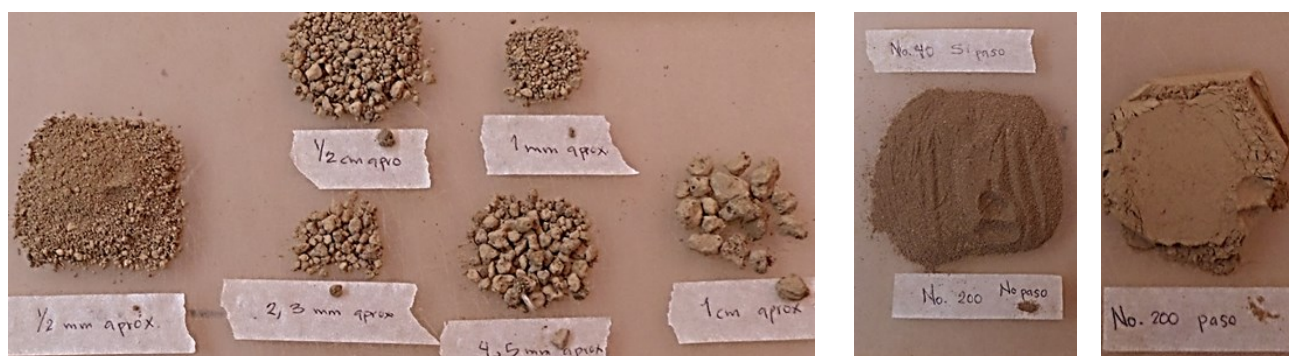
Img.40 "LABPYSCT" (2018) Identificación de la granulometría del suelo realizado con tamices de distintos calibres. [Fotografía ilustrativa del resultado]. Equipo de seminario.
