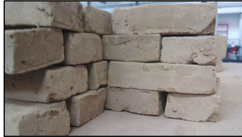
Este diseño de aparejo está estudiado y analizado para evitar las fracturas por sismo en las edificaciones
