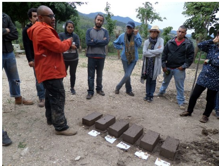
Img. 45 "LABPYSCT" (2018) Arq. Marcos Sánchez. Lectura de contracción, proporciones de mezclas.
