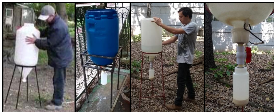
Fig. 32. De Izq. a Der. Dispositivo de precipitación utilizado por la IAEA. Primer intento de réplica. Dispositivo final construido para este trabajo. Recipiente de 1L donde se captura el precipitado.
