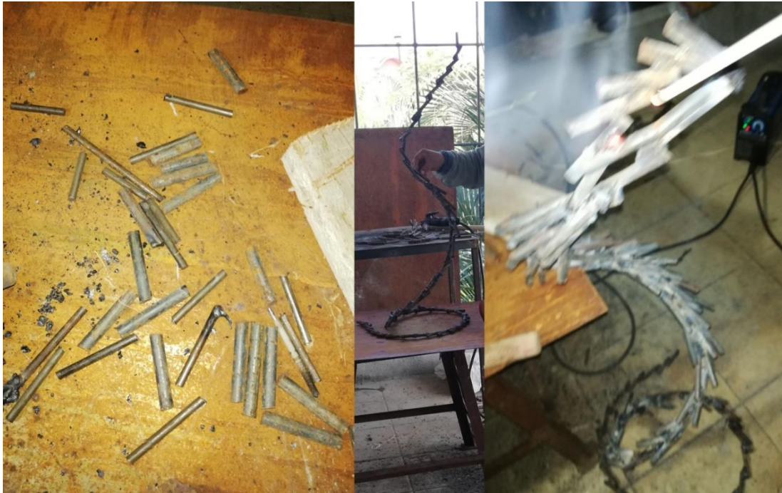
Fig. 180. Corte, soldeo y armado de trozos de tubo metálico. Fotografía de Leticia Arcos, 2019.
