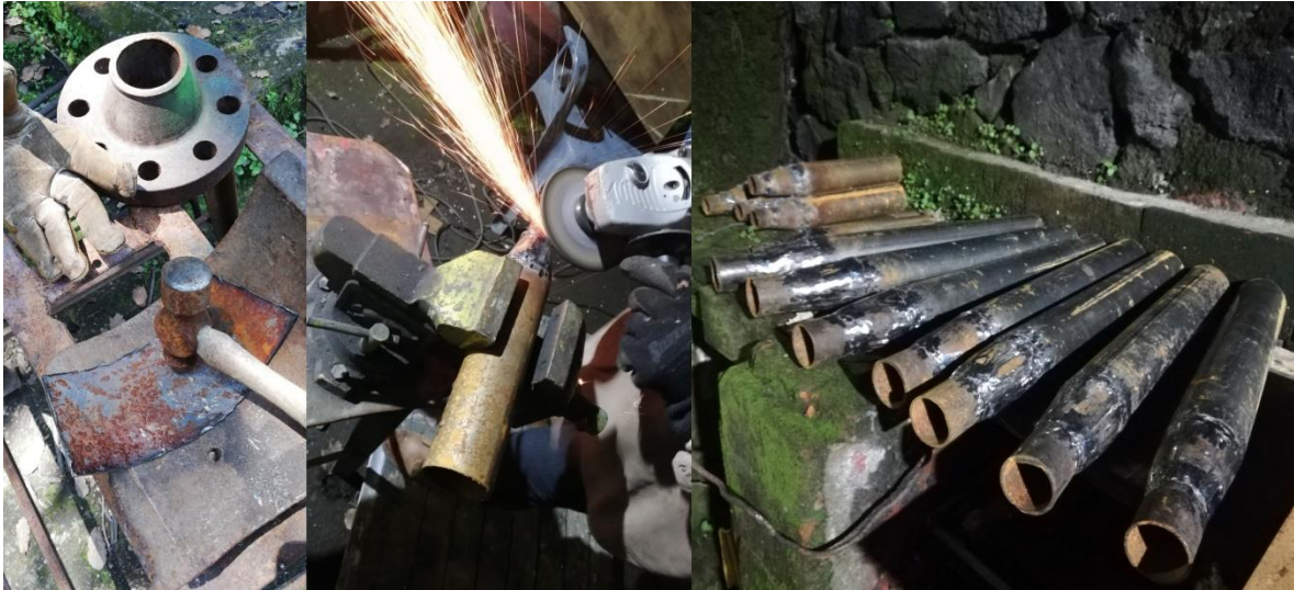
Fig. 159. Corte, forja, armado y pulido de tubos metálicos. Fotografía de Leticia Arcos, 2019.
