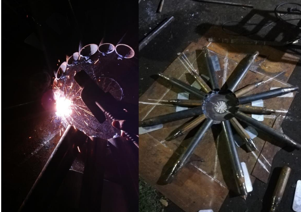
Fig. 168. Soldeo y armado de tubos metálicos para pieza solar. Fotografía de Leticia Arcos, 2019.
