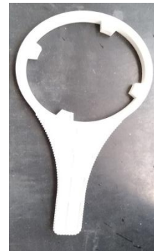
Fotografía 10. Llave para abrir y cerrar filtros
