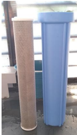
Fotografía 11. Filtro de carbón activado
