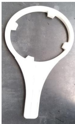
Fotografía 3. Llave para abrir y cerrar filtros.
