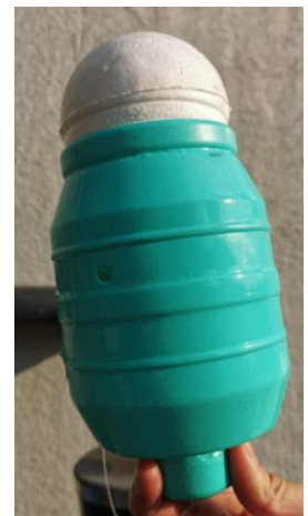
Foto 6. Dosificador de cloro..
