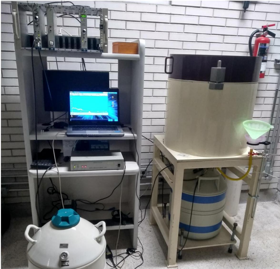
Figura 6. Dispositivo experimental para la caracterización por espectroscopía gamma. Foto: D. Belmont.
