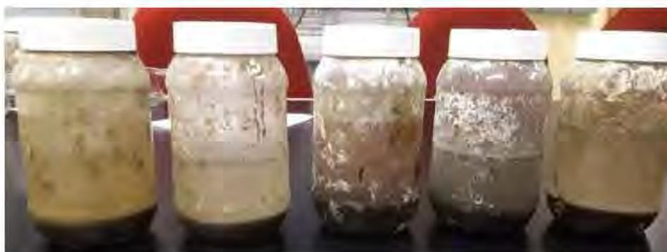
Figura 3.5: Recipientes de captura de sedimentos desmontados de las trampas usadas.
