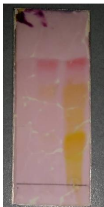
Figura 10. Revelado con vainillina sulfúrica, la coloración rosa es indicativo de la presencia de pinocembrina
