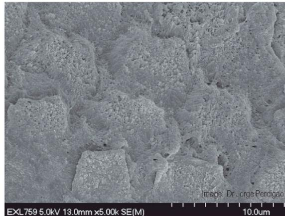
**Fig. 44** Imágenes al SEM de la superficie del esmalte dental autograbada con el Adhesivo Single Bond™ Universal.<sup>40</sup>
