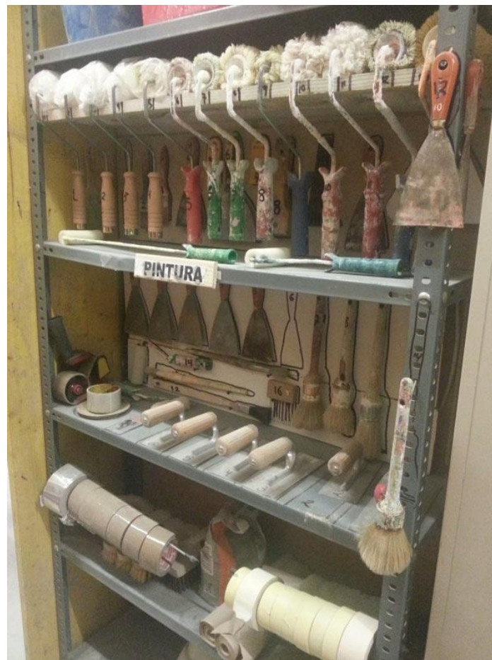
Imagen 1. Implementación de 5s en la obra Fotografía: Lean Management , Juan Felipe Pons Achell
