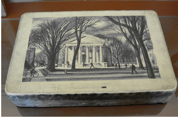
fig. 7 Imagen lista sobre la matriz de piedra para ser estampada sobre el sustrato
