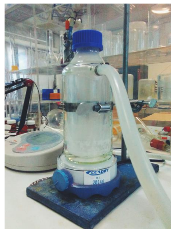
Figura 2.1. Reactor batch de doble pared con agitación magnética.
