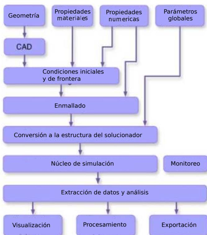
Figura 5.1: Jerarquías de los procesos para diseñar una simulación en SPIS. [Anuar, 2013]
