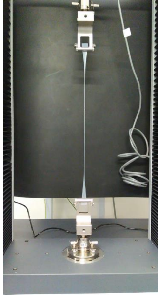
Fig. 4.15 Espécimen tipo D ensayado a una velocidad de 500 mm/min
