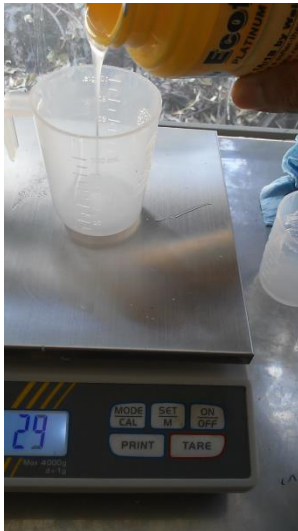
Fig. 4.6 Medición de Parte A: 7 gramos para la mezcla de Ecoflex 00-30.
