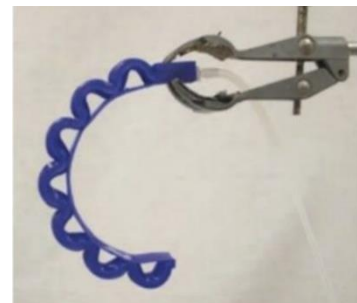
Fig. 3.3 Actuator de flexión neumático hecho con manufactura aditiva [23].
