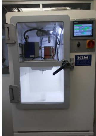
Fig. 4.9 Cámara de vacío V400A – KLM GmbH.
