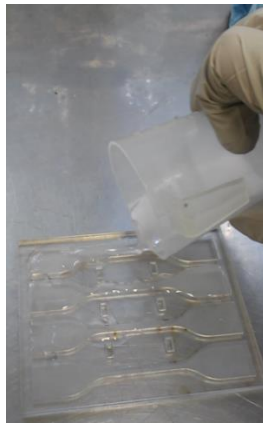
Fig. 4.11 Vaciado de mezcla en el molde (especímenes para el ensayo de tracción tipo D).
