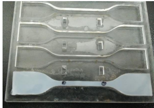
Fig. 4.12 Espécimen tipo D curado y marcado previamente, distancia entre marcas 25 mm.
