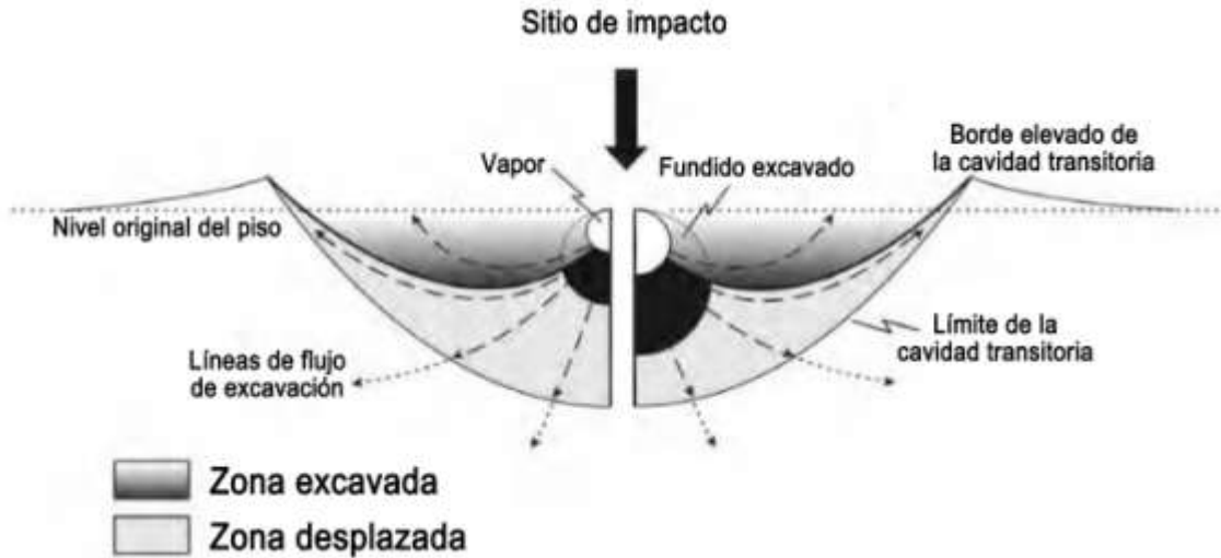
Figura 2.1. Etapa de excavación. Corte transversal del cráter en formación donde se muestra las zonas que se excavaron y las del material desplazado debido al impacto. Obtenida de Osinski y Pierazzo (2013).
