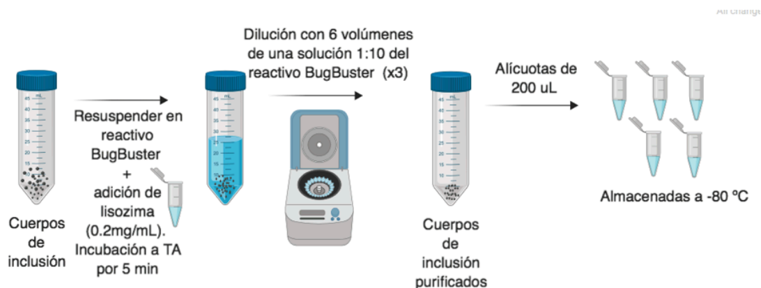
Figura 6:1 Esquema del proceso de purificación de cuerpos de inclusión
