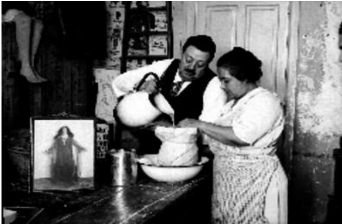
Figura 72: Dilea Castillo y José Neira Ocejo vaciando cera en un molde de yeso. 1940-45. Foto: Archivo Casasola, imagen: http://mediateca.inah.gob.mx
