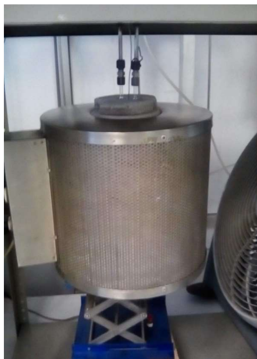
Figura 4.5.3 Horno donde se coloca el reactor en forma de U para calentar las muestras.
