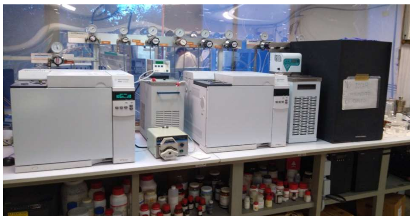
Figura 4.6.2 Sistema de reacción fotocatalítica de producción de hidrógeno.
