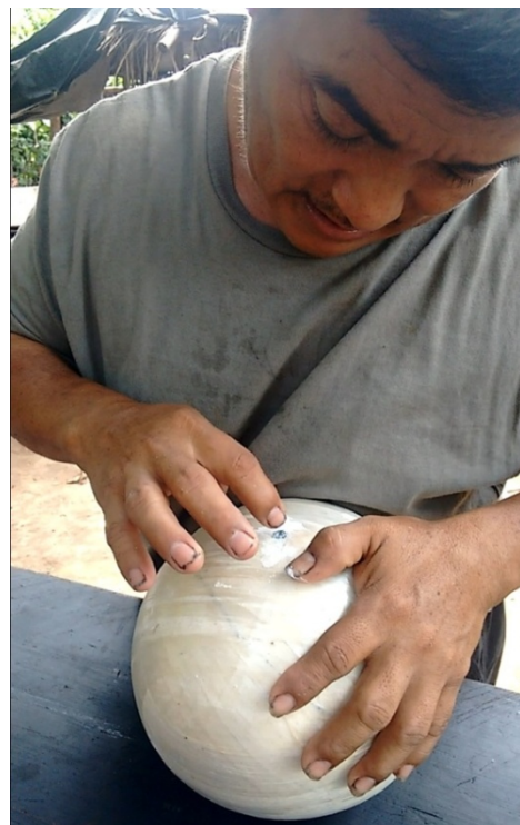
Figura 97 f. Tratamiento final para la válvula de inflado.
