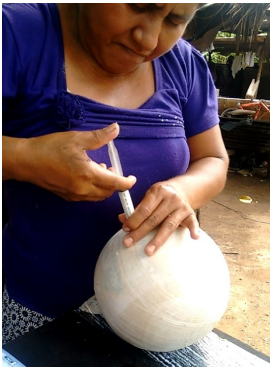
Figura 97 e. Inyección de hule líquido.
