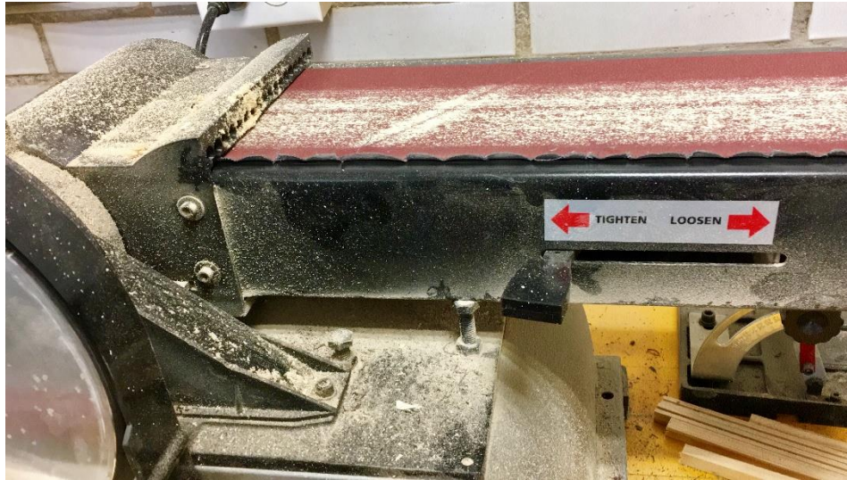
Figura 3.14. Lijadora mecánica en la cual se pulen las muestras, tanto núcleos como secciones. En este proceso son ocupadas lijas que van de 60 a 120 de grosor.
