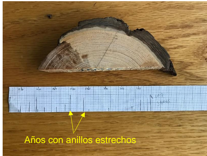
Figura 3.16. Ejemplo de la construcción de un esqueleto dendrocronológico. En el papel milimétrico solo se indican los años con anillos estrechos a partir de líneas, en función de lo estrecho será el largo de la línea.
