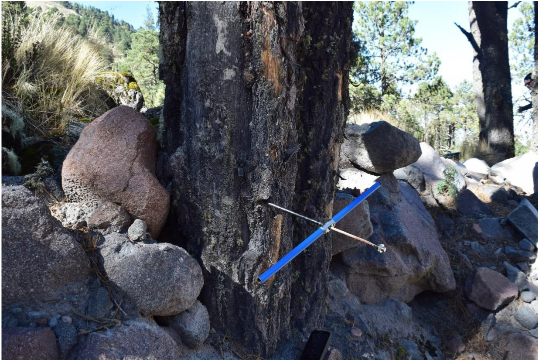
Figura 3.4. Extracción de un núcleo de Pinus hartwegii utilizando un barreno Pressler .
