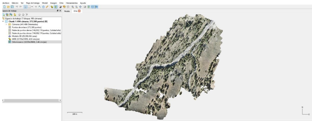
Figura 3.12. Fotomosaico creado a partir de la unión de las fotografías aéreas digitales tomadas con el dron.
