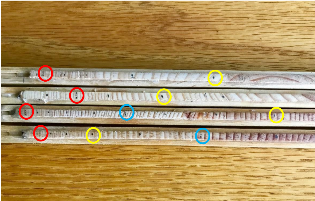
Figura 3.15. Ejemplo de 4 núcleos prefechados a los cuales se colocaron las marcas pertinentes. En rojo se indican los tres puntos, en azul dos y en amarillo uno, que corresponden a periodos de 100, 50 y 10 años, respectivamente.
