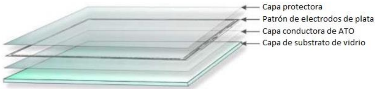
Imagen 1.2 Superficie táctil capacitiva elaborada por ADmetro [3].
