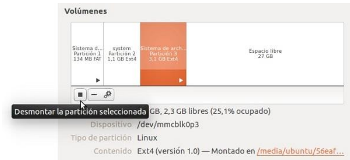
Imagen 4.33 Desmontaje de la partición 3 con la aplicación Discos.
