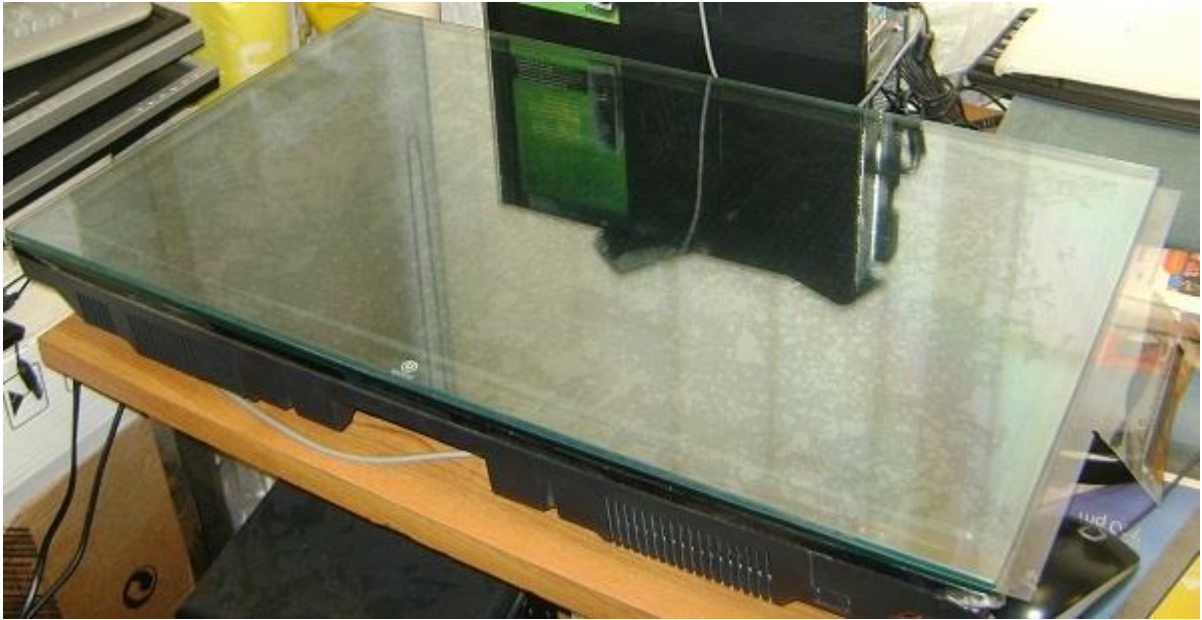
Imagen 3.4 Montaje de la película y las capas de vidrio sobre la pantalla.
