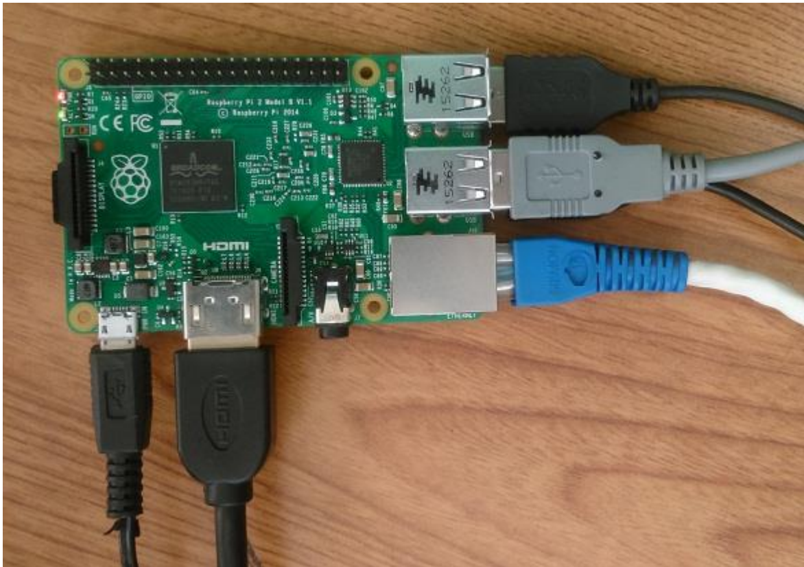
Imagen 3.7 Conexión de la Raspberry Pi 2B con los periféricos.
