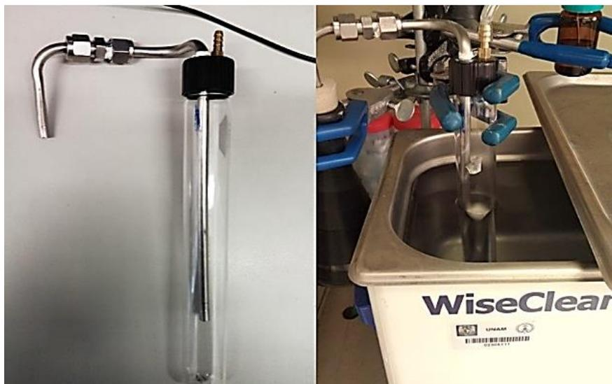
**Figura 9. Celda de tubo de vidrio de bajo volumen y proceso de termodesorción**
