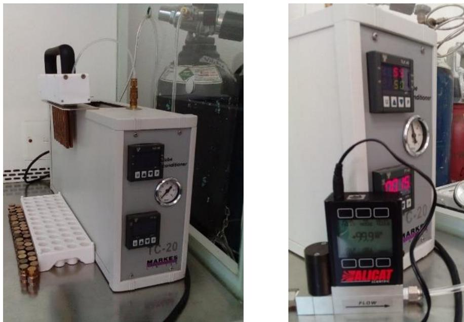
**Figura 16. Acondicionamiento de tubos de termodesorción**
