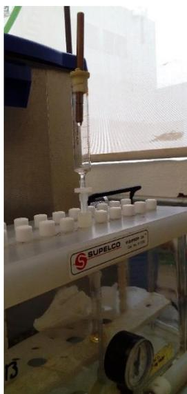
**Figura 17. Extracción de los analitos resorbidos en los tubos de absorción**
