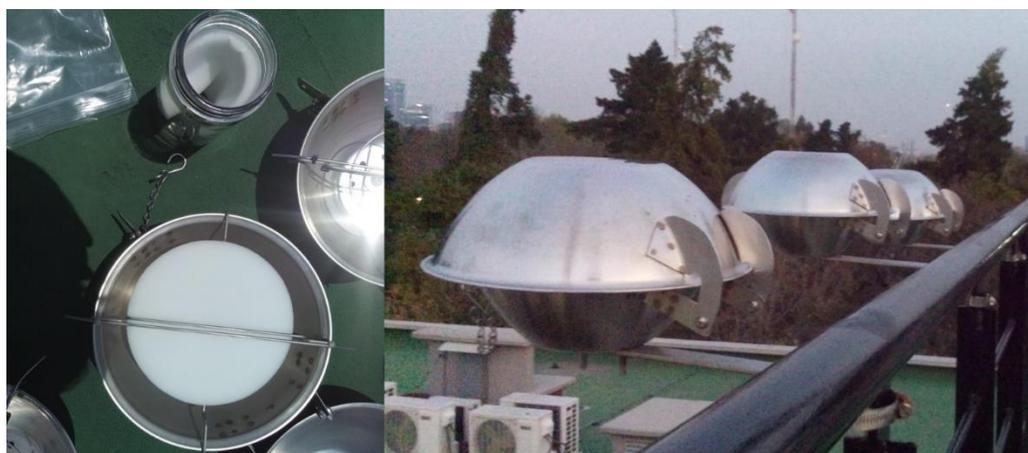
**Figura 3. Espumas de poliuretano (izquierda) y muestreadores pasivos (derecha) del aerosol atmosférico**
