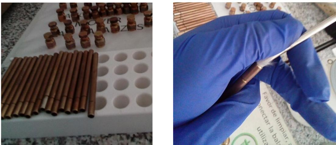
**Figura 15. Proceso de empacado de tubos de termodesorción con adsorbentes y fibra de vidrio**
