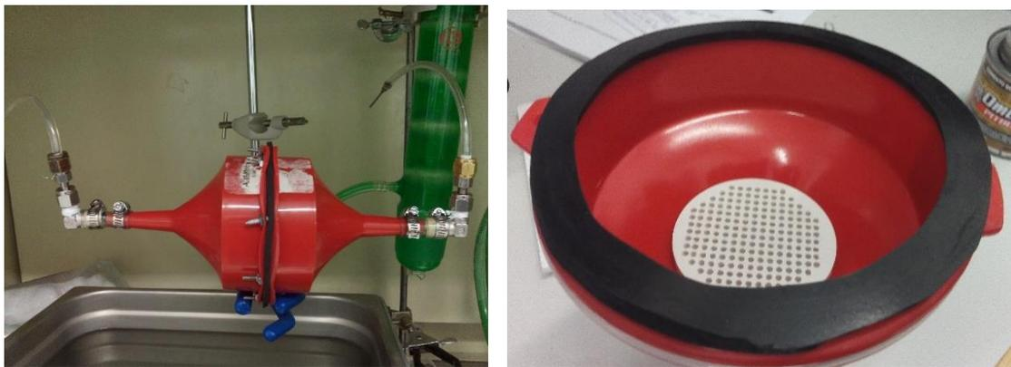
**Figura 7. Celda plástica bicónica de alto volumen con rejilla interna**
