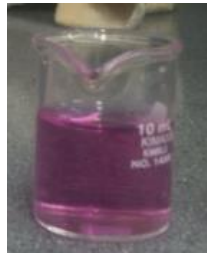
Figura 24.- Producto de reacción formado para nitritos utilizando el Microchip C
