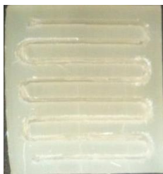
Figura 23.- Microchip C (Profundidad de 0.3 cm y 0.15 cm ancho de canales, orificios de entrada de 0.11 mm de diámetro, dimensiones de la caja 1.80cm x 2.10m x 0.5cm). (Anexo 8)
