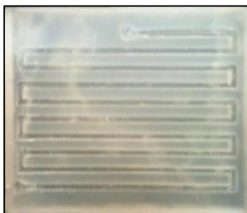
Figura 21.- Microchip B (cuadro base 2.20cmmX2cmX0.5, orificios de entrada 0.11cm, 0.30cm de profundidad, 0.15cm ancho de canal)
