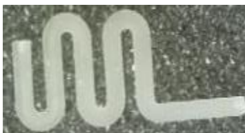
Figura 18.-Impresión del chip C. (Diámetro interno 0.15cm, grosor externo 0.30cm, longitud 3.5cm, rectas 1.5cm, curva 0.25cm)
