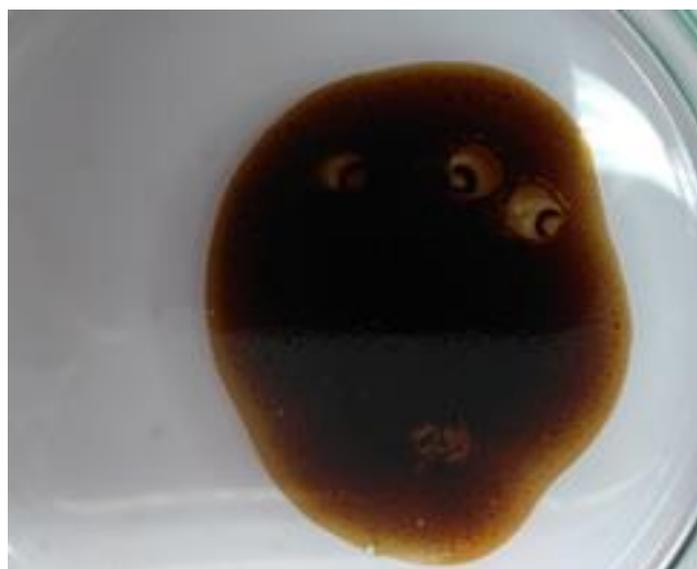
Fig. 10. Resultados positivos de la prueba "oil spreading" para detección de biosurfactantes.
