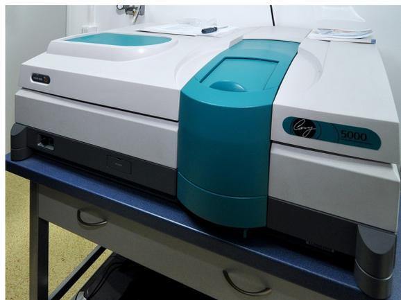
Fig. 4.3. Espectrofotómetro UV – Vis NIR Cary 5000<sup>[6]</sup>.
