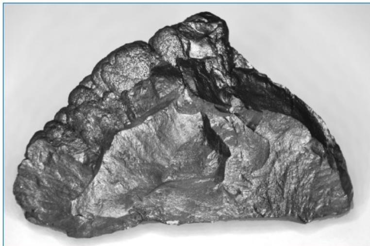
**Fig. 1.1.** Silicio pureza 99.999 %<sup>[13]</sup>.
