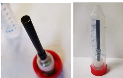
Figura 3.23: Electrodo de carbón vitreo, modificado con NP AuPd/C y tapa para el secado
