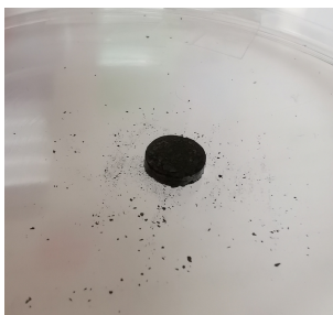
Figura 3.17: Pastilla hecha con polvo de NP soportadas en carbón vulcan
