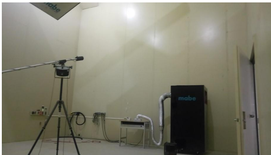
Figura 4.11. Foto del ensayo: micrófono rotativo, aditamentos para la medición y la configuración para las mediciones del nivel de presión acústica generado por una campana dentro de una cámara reverberante acorde a la ISO-3741 [67].
