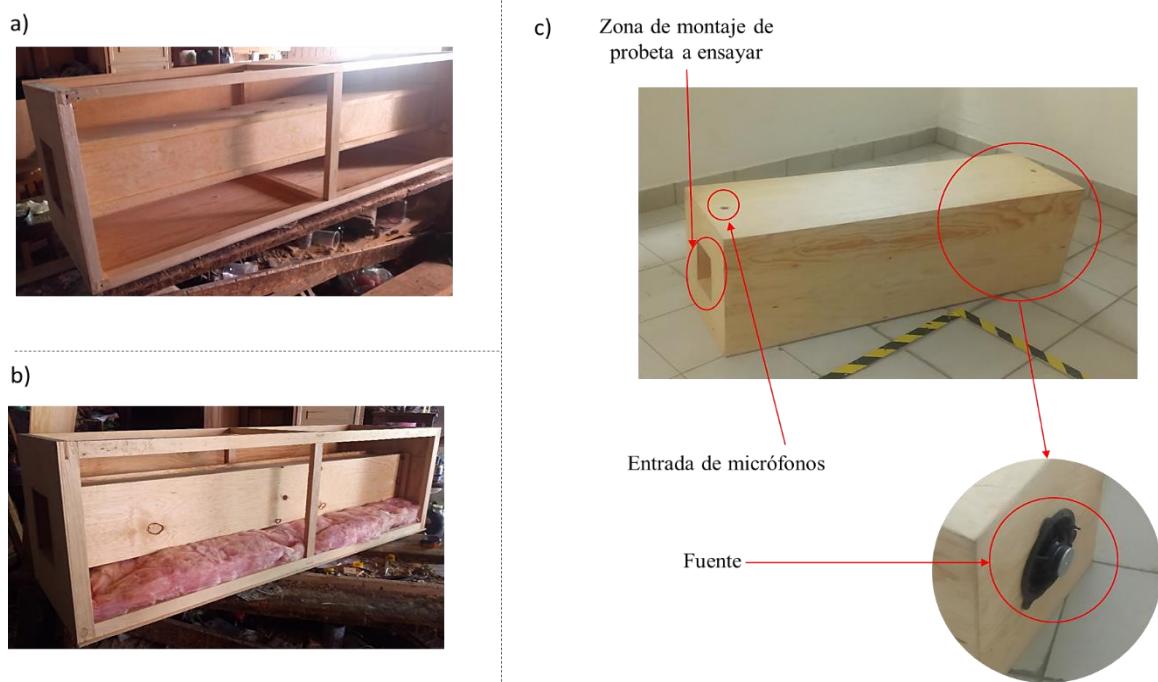
Figura 3.21. Construcción de cámara (caja) para la medición de CLF: (a) Estructura de cámara; (b) Colocación de acusfibra; (c) Zonas de localización de probeta a ensayar, entradas de micrófonos y fuente sonora.
