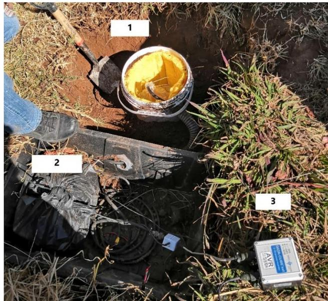
Figura 3.2. Tipo de instalación de la estación AC03. La numeración indica los distintos elementos de cada una de las estaciones: 1) Cubeta con sensor de velocidad y material aislante, 2) batería y controlador de carga y 3) registrador Data Cube.
