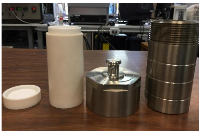
Figura 2.1 Autoclave para la síntesis hidrotermal.
