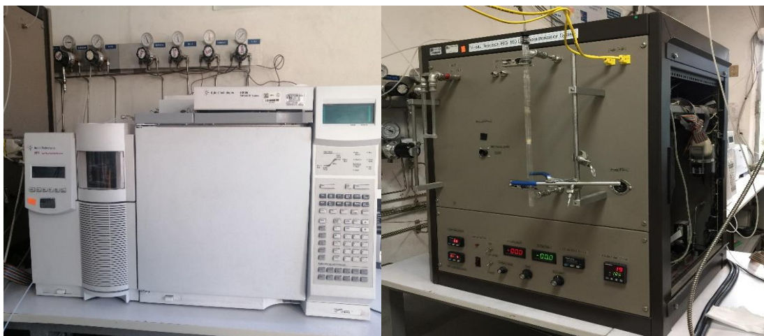
Figura 2.3 Cromatógrafo de gases y equipo in situ Research RIG-150 para reacción de hollín.
