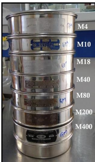
Figura III.11. Tamices apilados de mayor a menor en tamaño de abertura de mm para la separación de los distintos tamaños de grano.
