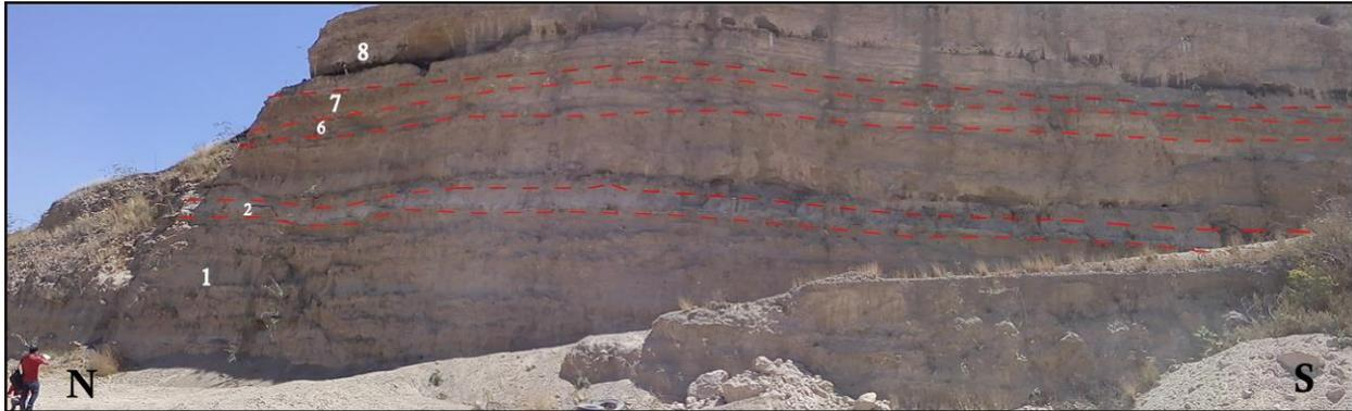
*Figura IV.6. Afloramiento del banco de material BM Libramiento Norponiente con dirección N-S y 23 m de espesor. Los números representan el número de estrato en las descripciones y las líneas puntadas los contactos entre los estratos.*
