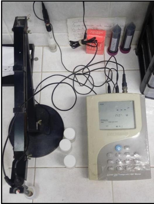
Figura III.9. Potenciómetro para medir el pH y la temperatura de las muestras. Marca BECKMAN. Los frascos blancos contienen las soluciones buffer para la calibración.
