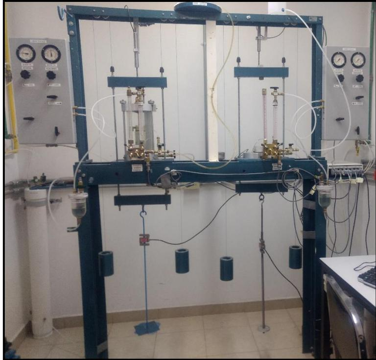
*Figura III.16. Equipo para ensayos triaxiales con muestra a prueba y las diferentes válvulas de presión y drenaje del sistema.*
