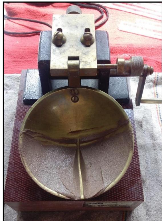
Figura III.14. Copa de Casagrande con muestra saturada durante la prueba de LL. La ranura a la mitad de la copa es la que debe cerrarse al menos 1.27 cm con cierto número de golpes.
