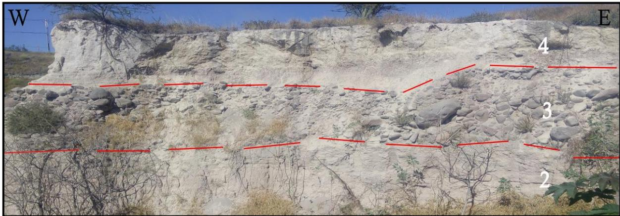
*Figura IV.8. Sitio del banco de material BM Antea con dirección E-W y espesor máximo de 15 m. Los números representan el número de estrato en las descripciones.*
