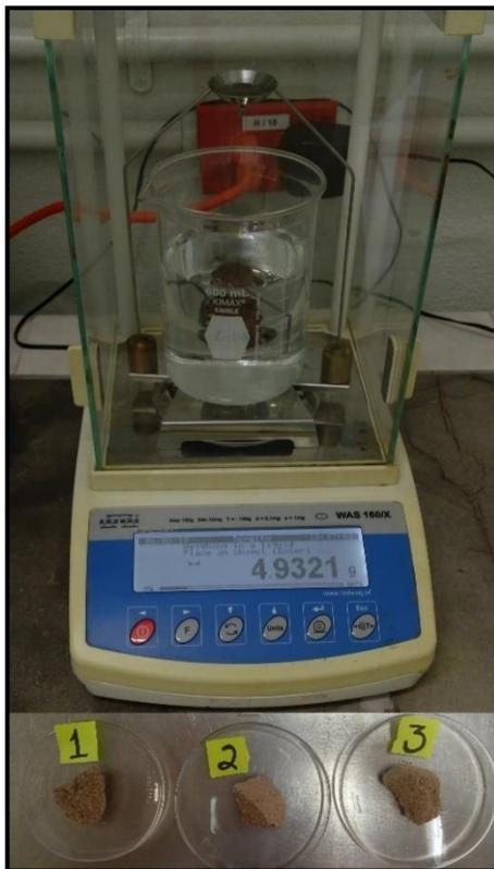
Figura III.6. Balanza con muestra sumergida en agua. Abajo se encuentran los 3 fragmentos de suelo con parafina antes de pesar.
