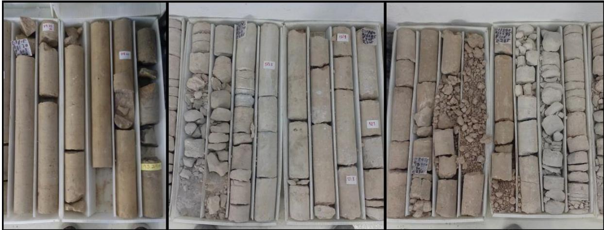
*Figura IV.25. Núcleos del pozo PQro2 que incluye los depósitos de la secuencia granular oligocénica TomPyLac con un espesor de 77 m.*
