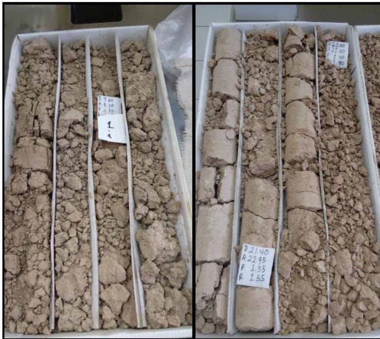
*Figura IV.24. Núcleos del pozo PQro1 que incluye los depósitos de la secuencia granular pliocénica TpArCg con un espesor de 47 m.*
