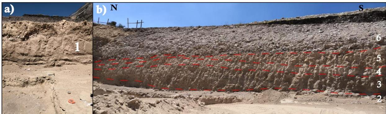
Figura IV.3. a) Estrato 1 en la base, se observa el aumento de tamaño de grano hacia la cima. b) Sitio del banco de material BM Torre Cápita dirección N-S con un espesor de 19 m. Los números representan el número de cada estrato en las descripciones.
