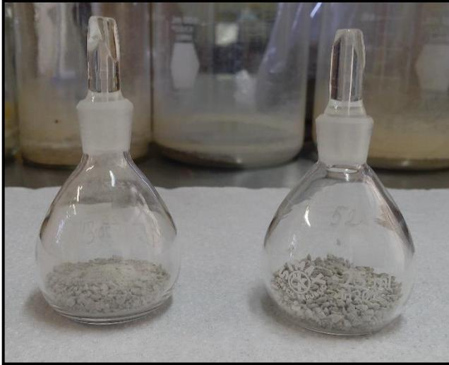
Figura III.4. Pícnómetros con 5 g de suelo para obtener el segundo peso indicado (por duplicado).
