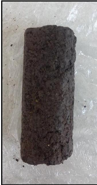
*Figura III.15. Muestra cilíndrica antes de someterla al equipo triaxial.*
