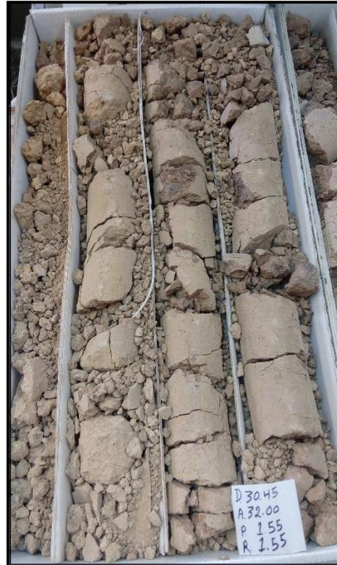
*Figura IV.28. Material disgregado de tamaño de grano limo-arenoso.*
