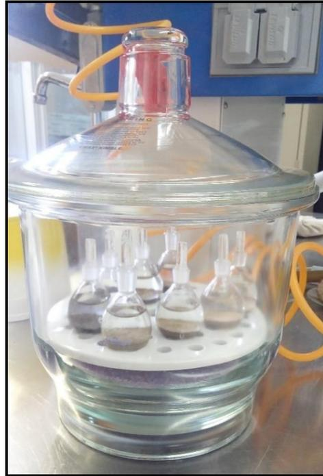
Figura III.5. Pícnómetros dentro del desecador para extraer el aire de la muestra y obtener el peso suelo + agua.
