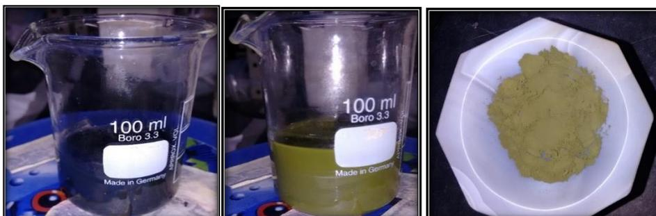
Figura 3.1. Procedimiento experimental para la obtención del compuesto de  $\text{Cu}_2\text{O-Co}_3\text{O}_4$ .
