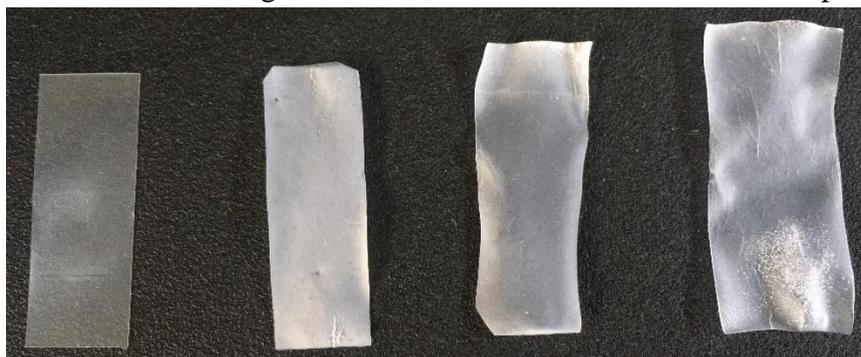
Fig.- 4.4.1.1. Cambio de dimensiones del material injertado PE-g-DMAAm.
