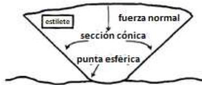
**Figura 3.1 Interacción de superficie y estilote de contacto mecánico convencional.**
