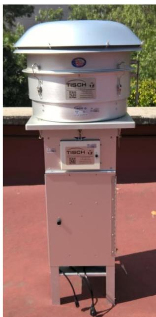
**Figura 9.** Muestreador de partículas de alto volumen.
