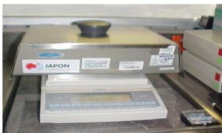
**Figura 8.** Balanza analítica para filtros usada en el C5 (RAMA).
