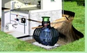
Agua grises: manejo Las aguas grises serán manejadas mediante un sistema de instalaciones indivisas (una por cada lote y local) que básicamente está compuesto por tanques de separación por flotación (grasas y detergentes), una fosa séptica y un pozo de absorción para el agua tratada. Este sistema disperso permite evitar las complicaciones de incorporar a una misma red desechos procedentes de habitación e industria emergente que de otra forma serían imposibles de tratar y cuya disposición representaría un riesgo ambiental.
