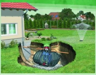
Captación de aguas pluviales Nuestro proyecto incluye la captación de agua pluvial. SGG tiene una precipitación pluvial anual de 1320.6 mm; la cubierta de una habitación mínima de 54m 2 puede proveer al menos 71.3m 3 de agua para una familia de 5 miembros; su captación llevaría a contar con cerca de 160% de la dotación actual o el 70% de la dotación ideal.
