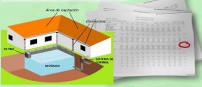
Captación de aguas pluviales Nuestro proyecto incluye la captación de agua pluvial. SGG tiene una precipitación pluvial anual de 1320.6 mm; la cubierta de una habitación mínima de 54m 2 puede proveer al menos 71.3m 3 de agua para una familia de 5 miembros; su captación llevaría a contar con cerca de 160% de la dotación actual o el 70% de la dotación ideal.
