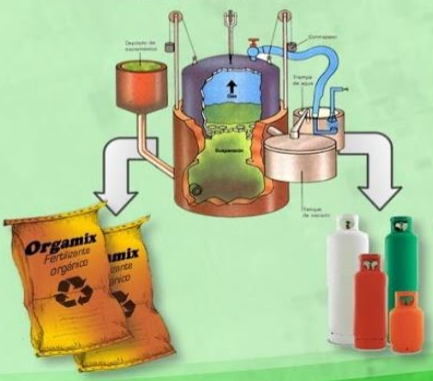
Agua negra: red y biodigestores Los sistemas serán colectados por una red de servicio y canalizados a una estación de manejo al suroeste del poblado dentro del "Distrito de servicios". El colector transportará la aguas grises a cárcamos de almacenamiento, tanques de separación sólido/líquido que después alimentarán biodigestores que finalmente entregarán gas metano y abono orgánico. Una comisión designada por las autoridades del poblado será la responsable de la operación de las instalaciones y la administración del capital obtenido por la comercialización de los subproductos de la operación.
